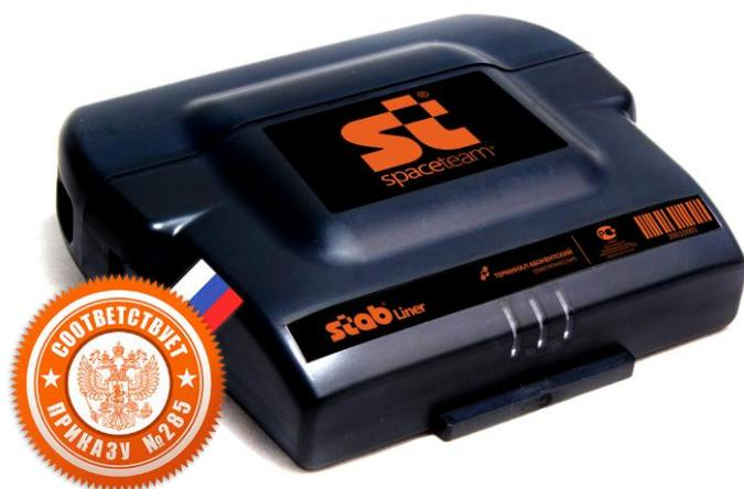
Абонентский телематический ГЛОНАСС/GSM/GPS терминал **STAB® Liner 100** – бортовое навигационно-связное устройство в составе навигационно-информационной системы мониторинга и управления транспортом производства SpaceTeam® холдинга.
