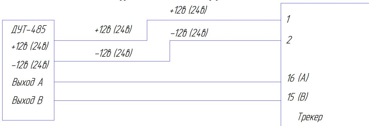
В настройках контроллера в поле [AT+STID](#) необходимо выставить сетевые адреса для каждого датчика подключенного к трекеру. Если подключаете более одного дуга, то также нужно включить в настройках контроллера «[Выдачу сообщений \\$AV,V7SD](#)».
