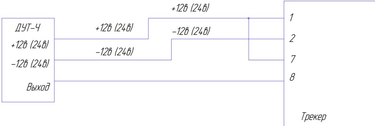
Схема подключения частотного датчика 2 (на дискретный вход 2):
