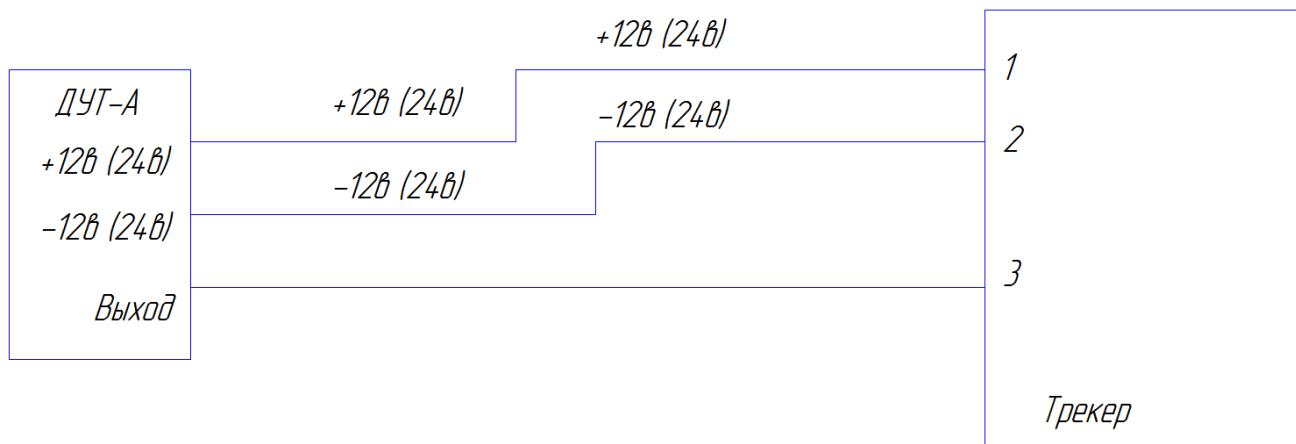
**Схема подключения датчика с выходом RS485**
