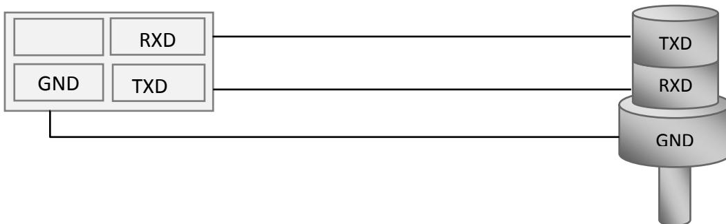
2. Настроить для канала RS232 Терминала получение условного уровня топлива или частоты с датчика. Это можно сделать, послав команду RS2320 (раздел [Настройка цифровых входов](#)) или через Конфигуратор на вкладке «Настройки»\«Цифровые входы». По умолчанию канал RS232 Терминала настроен на получение условного уровня топлива.
