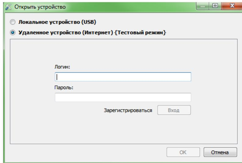
После успешной авторизации на сервере, будет доступна форма управления списком терминалов. При первом подключении список контролируемых терминалов будет пуст. Для добавления Терминала в список необходимо воспользоваться кнопкой «Зарегистрировать устройство». При регистрации Конфигуратор запросит пароль для конкретного Терминала, заводской пароль соответствует IMEI'ю Терминала, в дальнейшем пользователь может изменить его через Конфигуратор. Терминалы могут быть объединены в группы.
