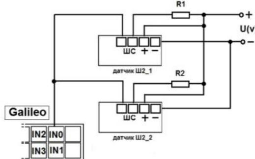
Порядок подключения 2x датчиков Ш2 через резисторы к одному из входов ДАВ Терминала.
