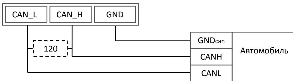
**Внимание** Если законцовочный резистор (на чертеже пунктиром) не стоит в шине на ответной стороне, то необходимо его поставить. Его наличие можно определить с помощью мультиметра: при выключенной электронике автомобиля произвести замер сопротивления между CAN\_H и CAN\_L. Если сопротивление порядка 60 Ом, то законцовочный резистор не нужен, если же сопротивление 120 Ом, то необходимо подключить обычный резистор 120 Ом между проводами CAN\_H и CAN\_L.
