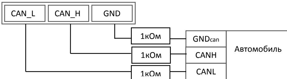
Для включения Терминала в диагностический разъем необходимо использовать первый вариант.
