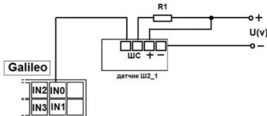
Для подключения 2x датчиков Ш2 к одному из ДАВ используем делитель на двух резисторах. Принцип подсчета реализован на изменении уровня напряжения при срабатывании датчиков.
