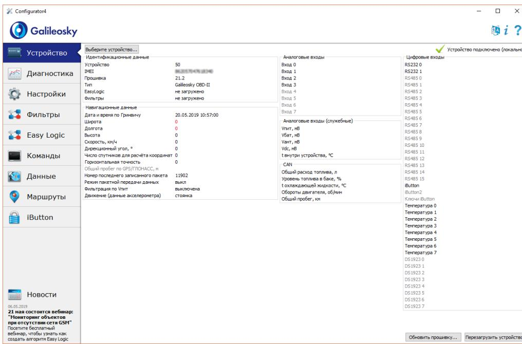
Если в терминале установлен PIN-код, программа запросит его для доступа к настройкам. При вводе неправильного кода Терминал отключится от компьютера, перезагрузится, вновь подключится к Конфигуратору и будет ожидать ввода правильного кода.
