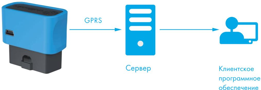
Информация на сервер передается посредством беспроводных сетей и далее по сети Интернет на пульт оператора.
