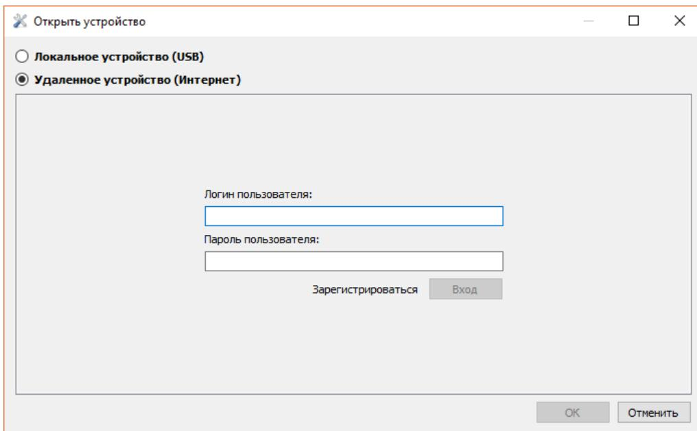
После успешной авторизации на сервере будет доступна форма управления списком терминалов. При первом подключении список контролируемых терминалов будет пуст. Для добавления терминала в список необходимо воспользоваться кнопкой «Зарегистрировать устройство». При регистрации Конфигуратор запросит пароль для конкретного терминала, заводской пароль соответствует IMEI'ю терминала, в дальнейшем пользователь может изменить его через Конфигуратор. Терминалы могут быть объединены в группы.
