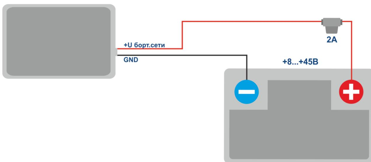
Рисунок 3 - Типовая схема подключения питания терминала
