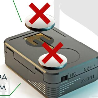
При экранировании GSM-антенны магнитом может пострадать качество GSM-сигнала. Уменьшится надежность передачи информации; возможны провалы в выходах в эфир, вплоть до полного прекращения передачи информации.
